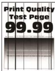
**Remarque** : Avant de résoudre le problème, imprimez les pages de test de qualité d'impression. A partir du panneau de commande, accédez à **Paramètres > Dépannage > Pages de test de qualité d'impression**. Pour les modèles d'imprimante sans écran tactile, appuyez sur **OK** pour parcourir les paramètres.
